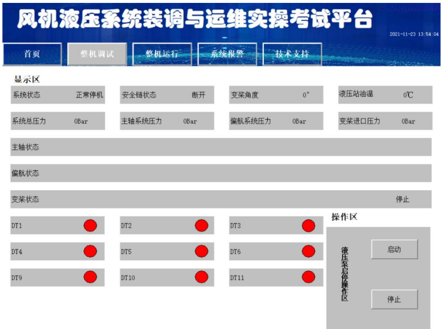
图 3-3-13 液压系统整机调试界面
