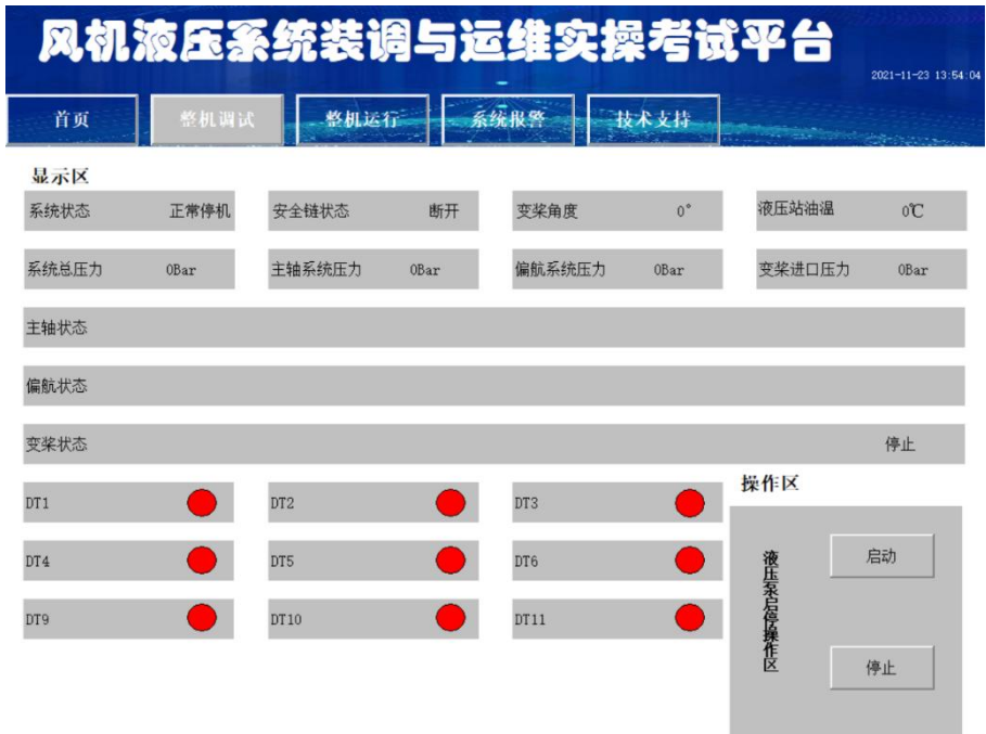
图 3-3-7 液压系统整机调试界面
