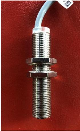
图3-69 接近开关示意图
