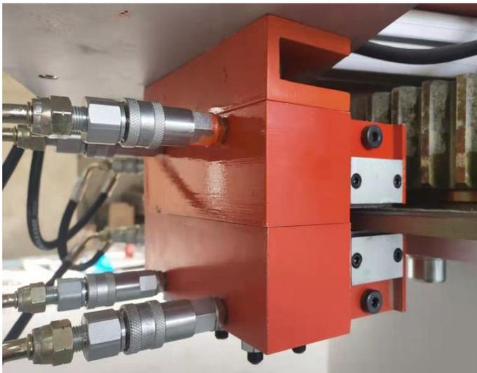
图 3-12 液压制动器安装示意图
