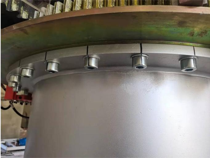
图 3-5 偏航轴承安装螺栓划线图
