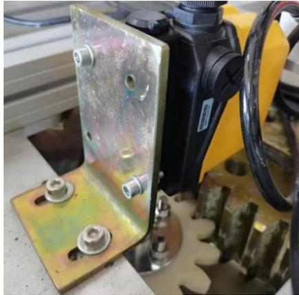
图 3-24 安装解缆开关支架
