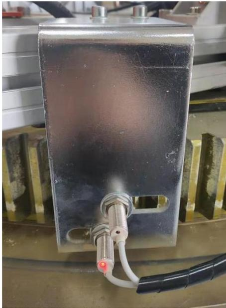
图 3-27 接近开关安装示意图
