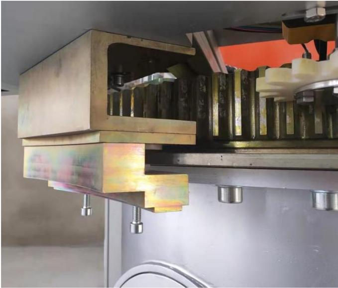
3-22 侧面轴承安装示意图
