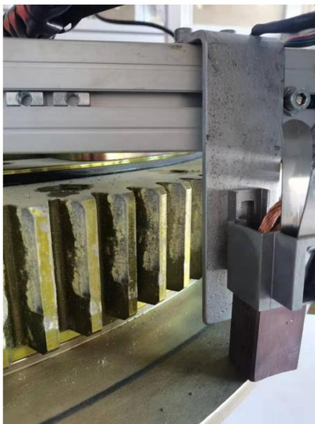
图 3-29 碳刷装配安装示意图
