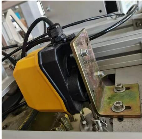
图 3-25 解缆开关安装示意图
