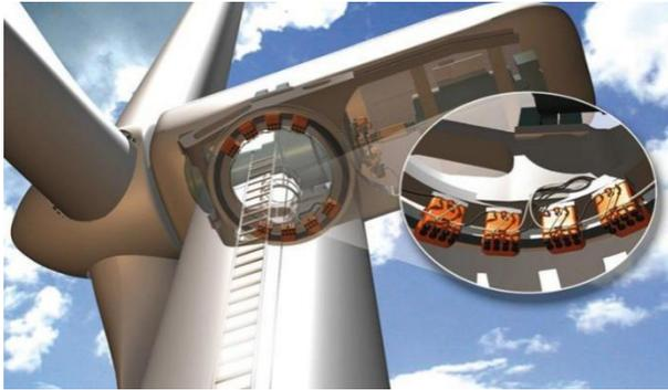
图 3-65 风电机组偏航制动器位置
