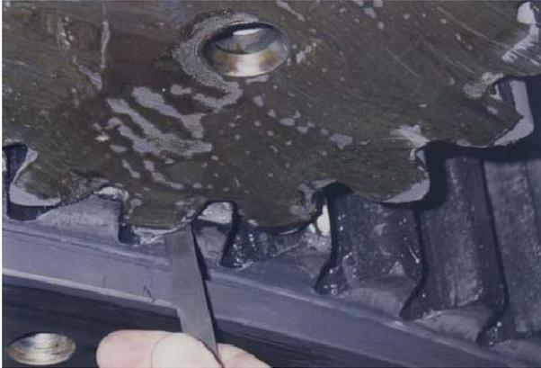
图 3-62 齿侧间隙测量方法
