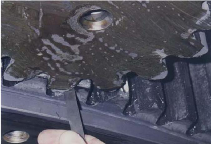
图 3-12 齿侧间隙测量方法
