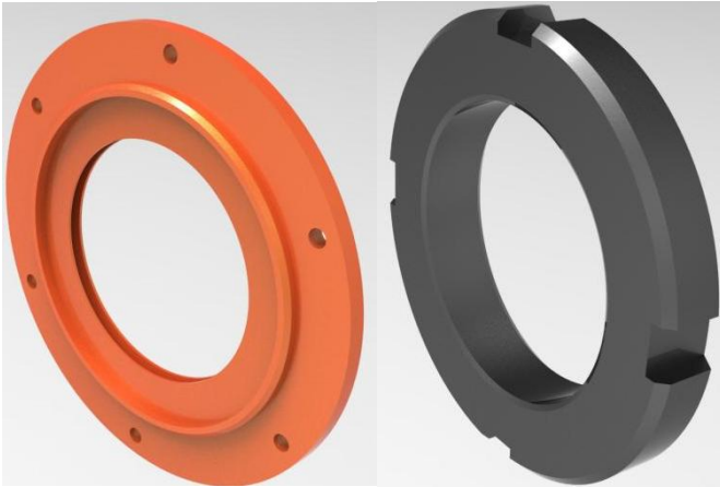
图 3-24 轴承座一后端盖（左） 圆螺母 M48x1.5（右）
