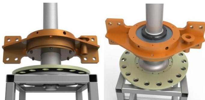
图 3-29 安装承座一（左） 安装圆螺母 M76x2（右）
