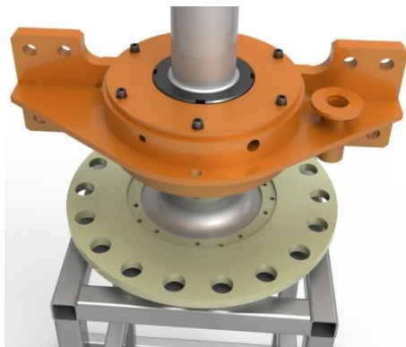
图 3-30 安装轴承一后端盖
